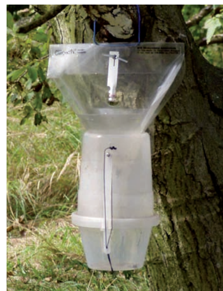
4. kép A nagy farontó rajzásmegfigyelésére használt nem telítődő varsás csapda
